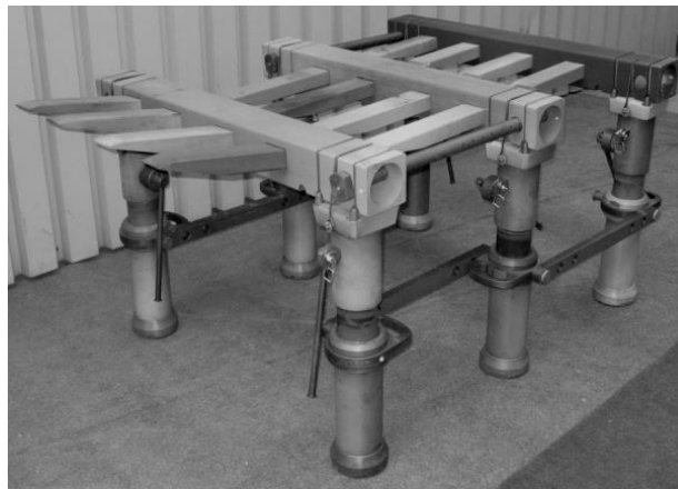
Rys. 3. Odrzvia obudowy chodnika ratowniczego K-400 [1]
