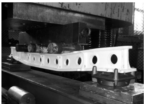
Rys. 10. Stropnica podczas prób wytrzymałościowych [Źródło: opracowanie własne KOMAG]
