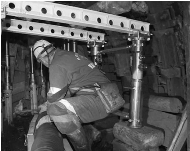
Rys. 15. Obudowa ratownicza HOR-01 w chodniku badawczym [7]
